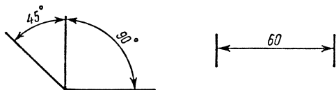
Рис. II.36. Примеры нанесения размерных чисел
